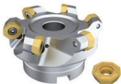
Новая серия фрез для обработки плоскостей с углом в плане 45° с острыми восьмигранными пластинами способна выполнять широкий спектр работ по чистовой и получистовой обработке. Конструкция с позитивными пластинами обеспечивает низкие усилия резания и повышенную стабильность, обеспечивая согласованность и надежность технологических процессов.
