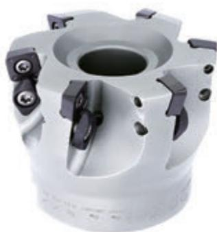
Инструмент для фрезерования с высокой подачей с углом в плане 15° обеспечивает максимальную производительность и надежность процесса. SDMT09T312-DM YBC205H отличается позитивной режущей геометрией, которая обеспечивает меньшее усилие резания. Это, в свою очередь, снижает вибрации и нагрузку на шпиндель при использовании фрез серии XMR01.
