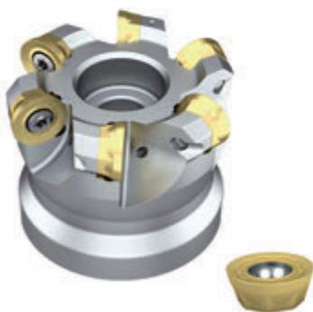
Система фрезерования с круглыми пластинами является идеальным выбором там, где целью является достижение максимальной скорости снятия металла в широком диапазоне применений. Позитивная геометрия режущей кромки обеспечивает обработку с низким уровнем вибрации даже при больших вылетах, а четкое позиционирование пластины обеспечивает оптимальное использование режущей кромки.
