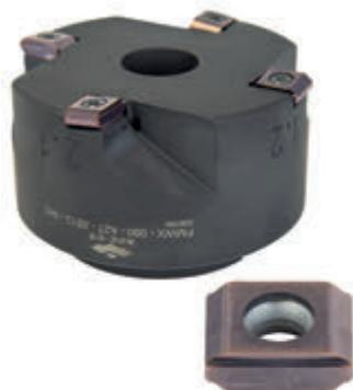
Фреза с зачистными пластинами Wiper для работы с высокой подачей была разработана для получения высококачественной поверхности деталей за короткое время. Поскольку посадочные места пластин изготавливаются с жесткими допусками, последующая регулировка высоты режущей кромки не требуется. Кроме того, внутренний подвод СОЖ улучшает удаление стружки из зоны резания, что увеличивает стойкость инструмента.
