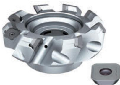
Благодаря правильной геометрии резания фрезы для обработки плоскостей с углом в плане 45° обеспечивают получение поверхностей высокого качества благодаря низким усилиям резания при низких требованиях к мощности станка. Широкий выбор стружколомов и сплавов доступен практически для любой операции при фрезеровании плоскостей.
